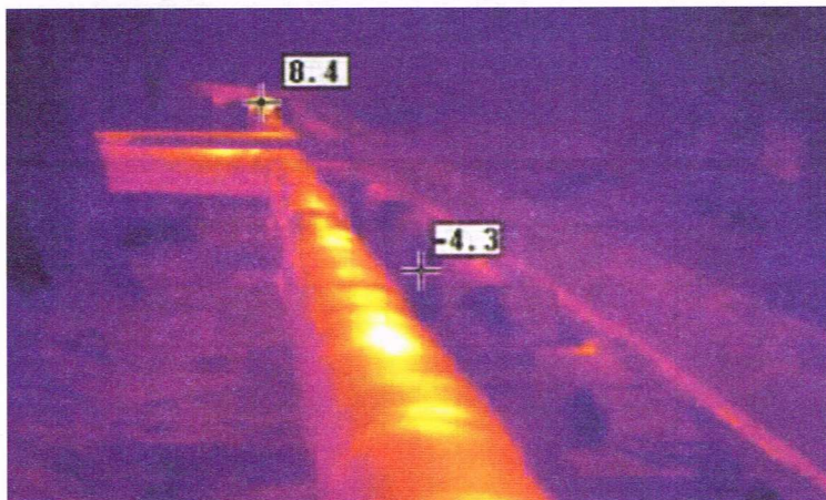
Porównanie sieci: w starej izolacji – świecenie; obok, w nowej izolacji – brak świecenia
