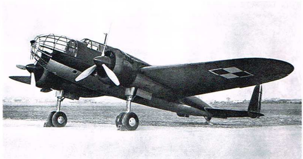
PZL.37 Łoś – polskiej konstrukcji i produkcji dwusilnikowy bombowiec zbudowany w układzie dolnopłata o konstrukcji całkowicie metalowej z podwoziem chowanym w locie (źródło – Internet)
